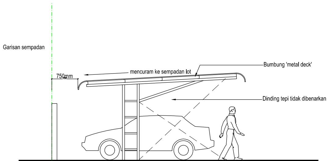
MINIMUM JARAK 750MM DARIPADA DINDING SEMPADAN LOT SERTA PEMASANGAN GUTTER / DOWNPipe TIDAK DIPERLUKAN
