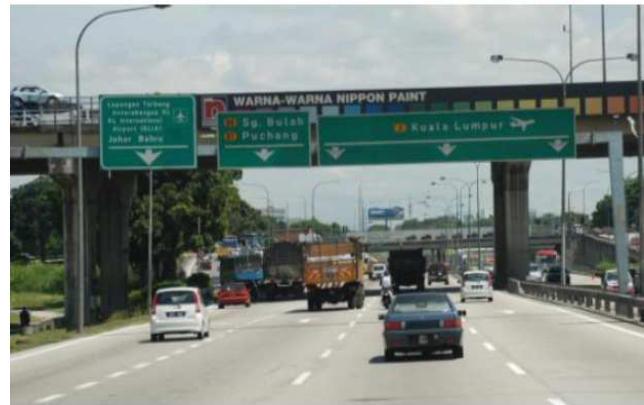
Papan iklan jejambat yang diletakkan berdekatan dengan papan tanda lalu lintas (traffic sign) menyukarkan pengguna untuk membaca papan tanda lalu lintas.
